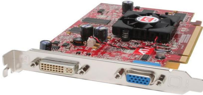
Figura 11: Uma placa gráfica, com os conectores típicos: DVI e VGA.
